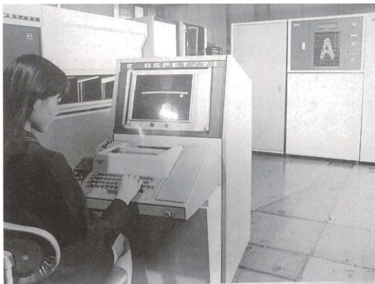
写真1.「ASPEET/71」の主要部分 操作用コンソールを中心に左後方が読取り装置、右側が演算処理装置で設置に当時の中型電子計算機ほどのスペースが必要であった。
